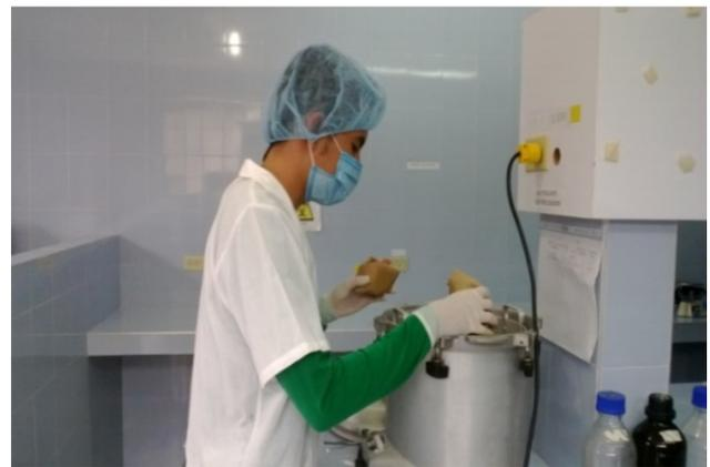
Para evaluar la eficiencia del filtro se tomaron pruebas fisicoquímicas y microbiológicas de la salida del agua del filtro teniendo en cuenta parámetros como: la cantidad de coliformes totales y fecales además de pH, turbiedad, conductividad y color aparente. Obteniendo los siguientes resultados.
