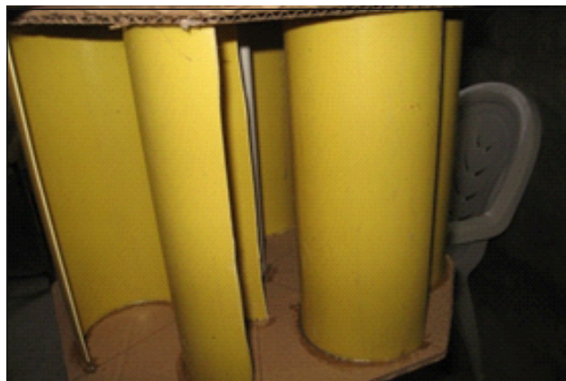
Fotografía 3. Aerogenerador en tubo de 2, 3 y 4 pulgadas
