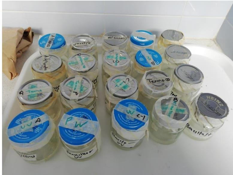
Transcurridos 4 meses de la prueba de biodegradación las láminas PET fueron retiradas, desinfectadas y pesadas procediendo a calcular el peso perdido y la eficiencia del proceso.
