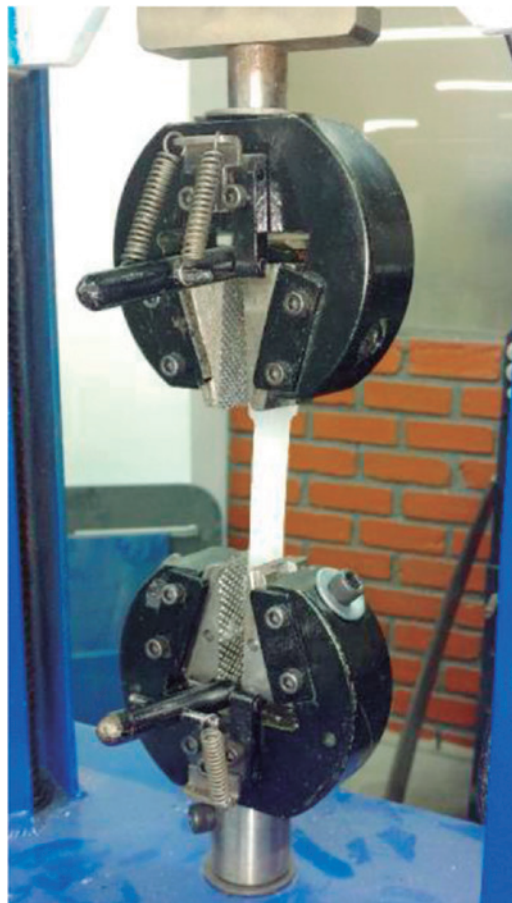
Figura 12. Ensayo de tensión sobre una probeta de nylon
