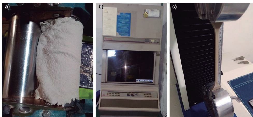
Figura 2. a) molino de rodillos; b) reómetro; c) máquina universal de tensión
