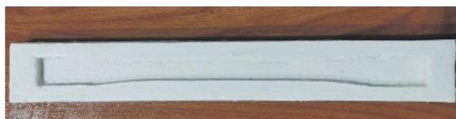
Figura 1. Molde de caucho siliconado
