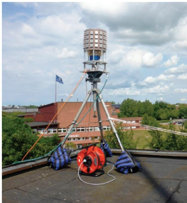
Figura 2. Prototipo en arreglo circular de 128 antenas sobre la Universidad de Lund.
