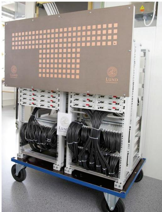
Figura 3. Prototipo LuMaMi en arreglo rectangular plano escalable de 128 - 160 antenas.
