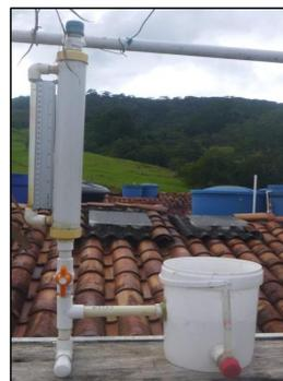
Figura 6. Análisis descriptivo medidores de evaporación
