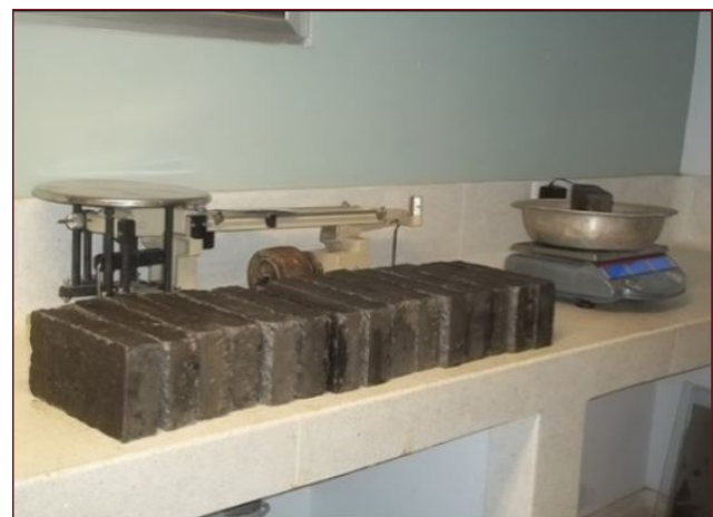
Figura 8. Pesaje de los ladrillos
