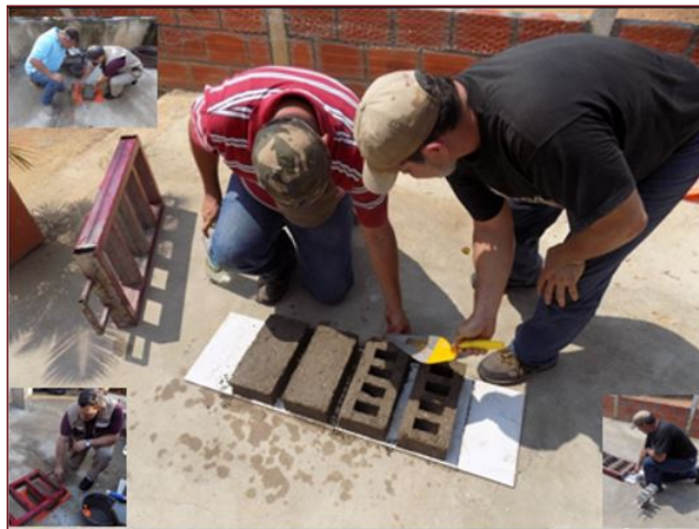
Figura 5. Desmolde de especímenes para los ensayos.
