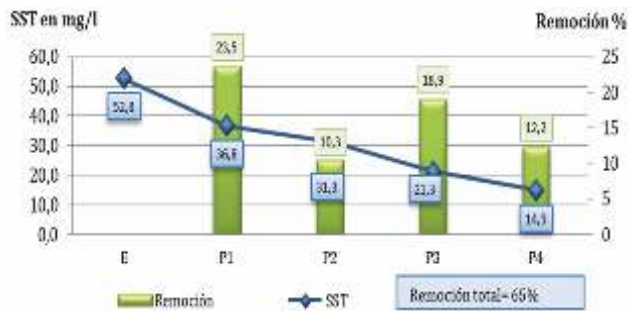
Figura 16. Remoción de sólidos suspendidos totales en las presas de control de sedimentos
