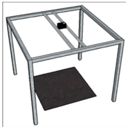
Figura 2. Estructura metálica de soporte
