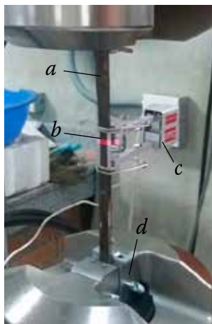
Figura 5. Montaje para pruebas en dirección longitudinal: (a) Probeta, (b) Medición por extensómetro láser, (c) Extensómetro, (d) Mordazas de la máquina.
