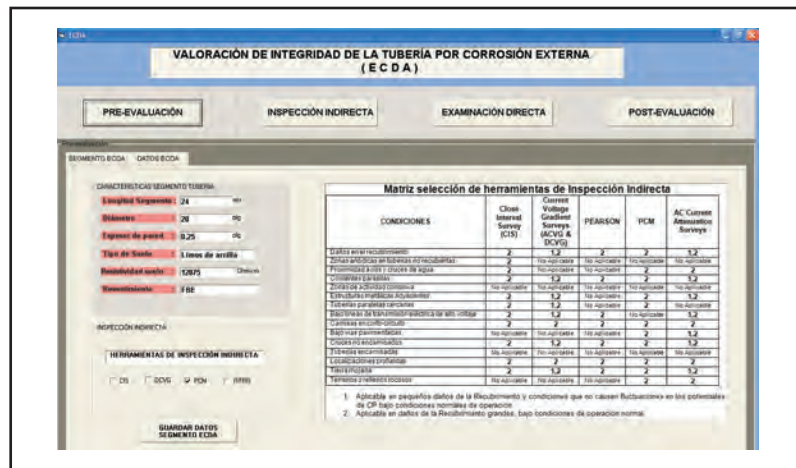
Figura 3 Valoración de integridad de la tubería por corrosión externa, pre-evaluación.
