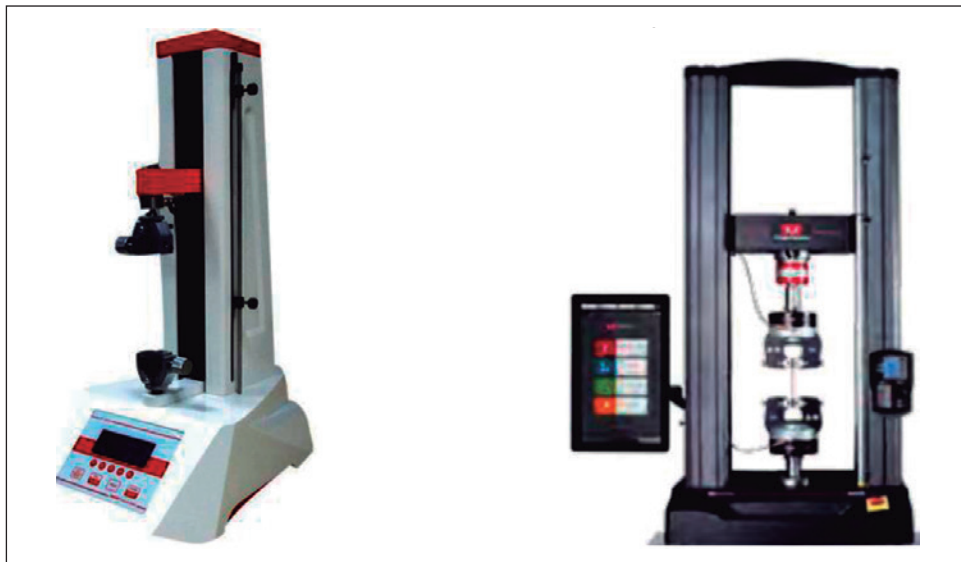
Figura 2. Dos configuraciones típicas de máquinas de ensayo: a) diseño a una sola columna, b) diseño de doble columna
