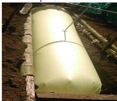
Figura 2. Modelo de biodigestor tubular en polietileno.
